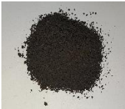
A 原料：水産加工協同排水処理施設汚泥
