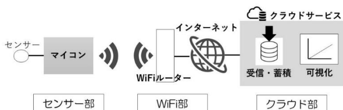
図2 リアルタイム可視化ツールの構成
